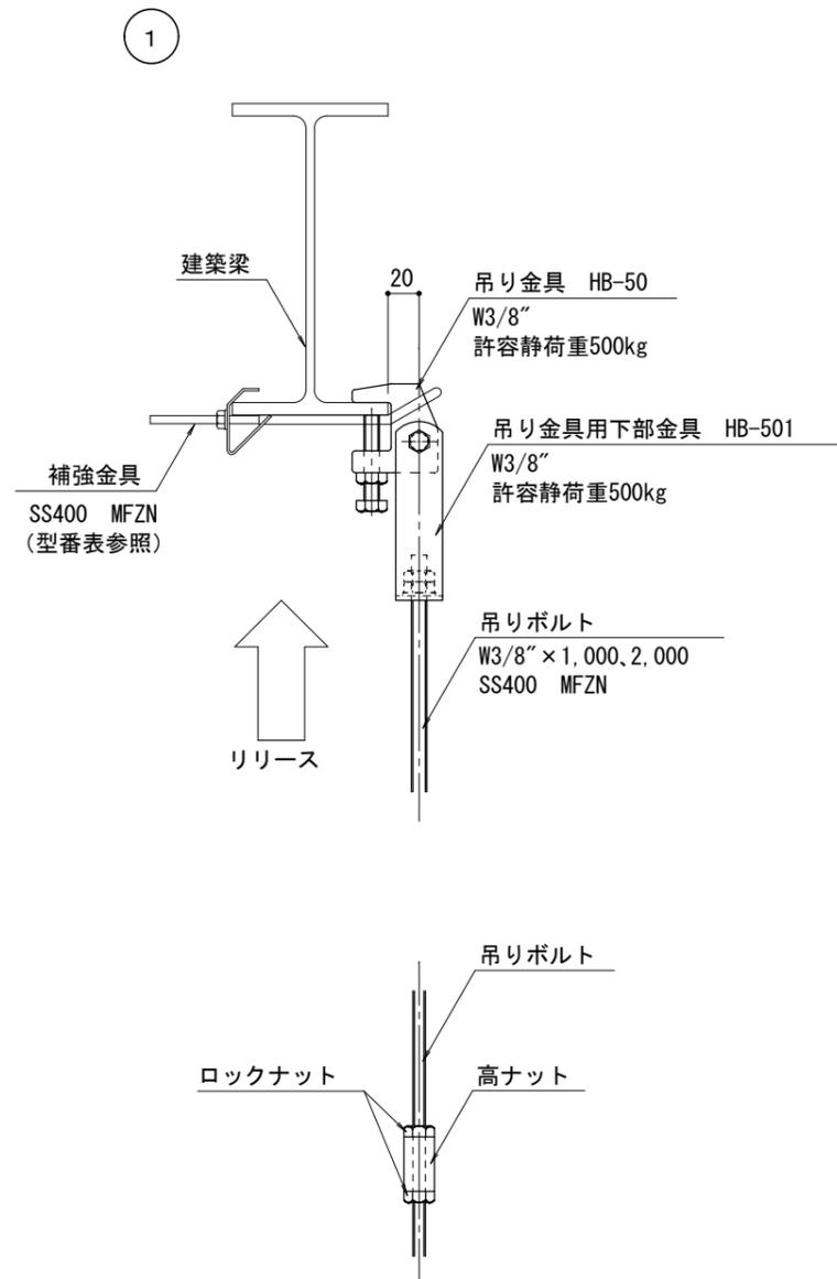
吊りボルト標準在庫 L=1,000, 2,000 右ネジ
